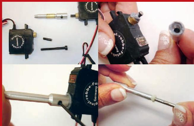
Der erste Arbeitsschritt ist das Abformen des Servo-Antriebszahnrades. Mit Flüssigtrennwachs den Abtrieb zwei bis drei Mal behandeln, dazwischen abtrocknen lassen. Das Epoxiharz (UHU-Plus Endfest 300) auf beiden Seiten auftragen und das Aluteil mit Drehbewegung aufsetzen. Anschließend die Madenschraube anziehen und mindestens zwölf Stunden aushärten lassen.
